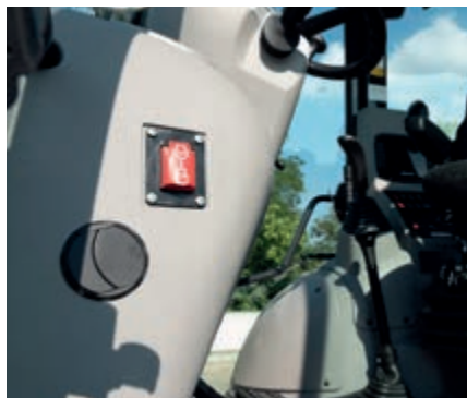
Interruptor de parada de emergencia del motor
