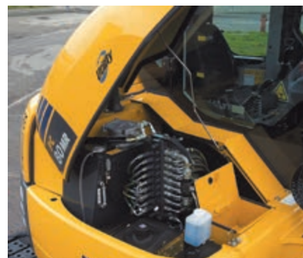
Capó derecho para un fácil acceso al grupo de válvulas principales, tanque de combustible, tanque de aceite y caja de herramientas
