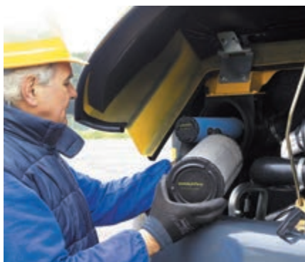
Capó trasero para un acceso e inspección rápida del motor y los puntos de mantenimiento
