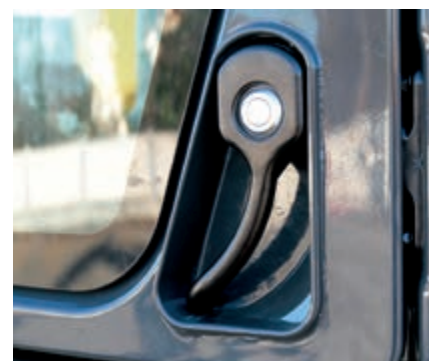
Fácil acceso a la cabina mediante palanca en posición baja de la puerta
