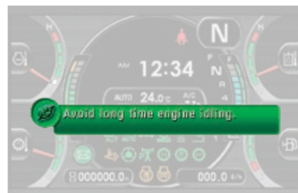
El guía de eficacia apoya el ahorro de energía en tiempo real (p. ej. evitar periodos largos al ralentí)
