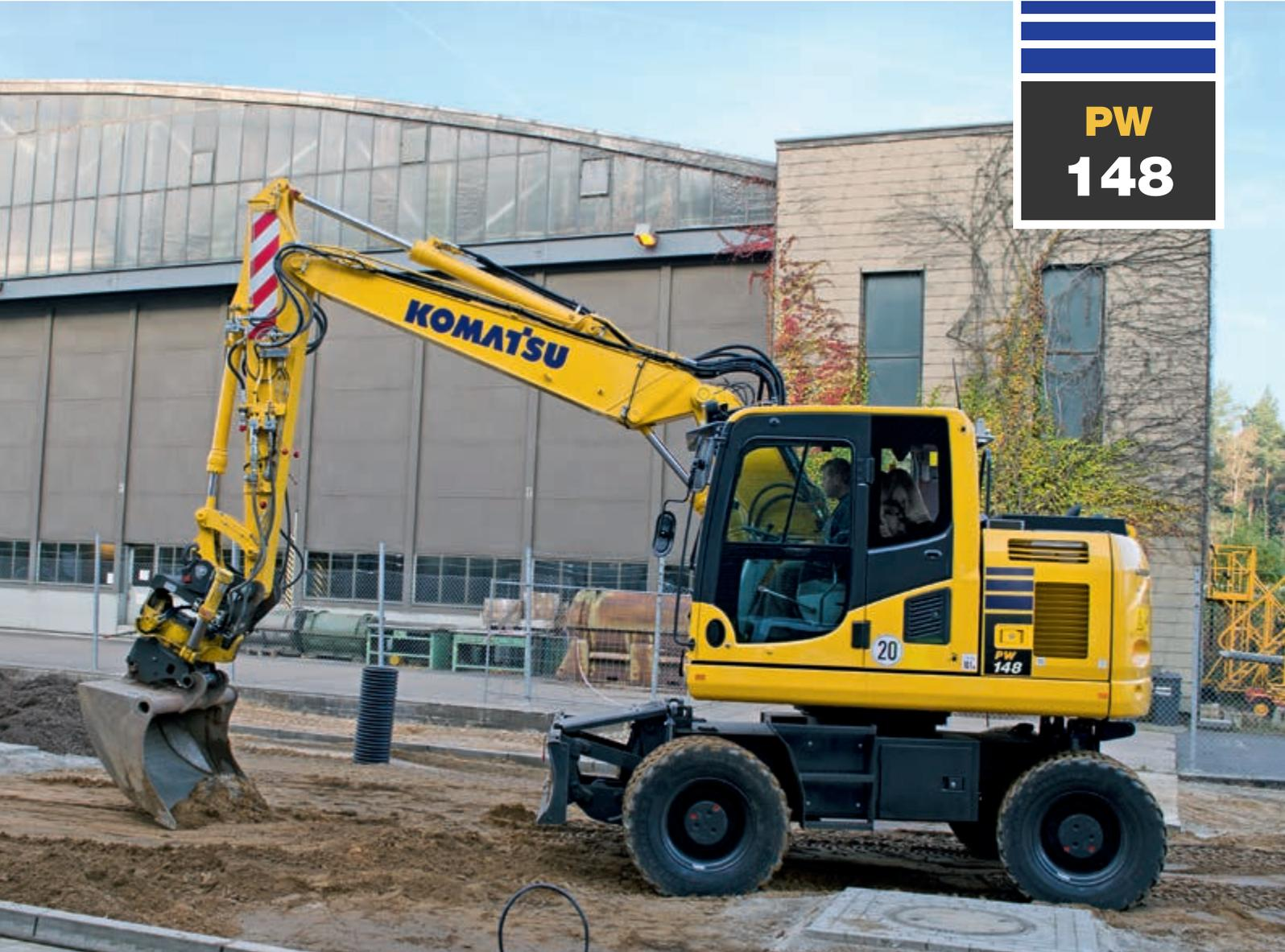
Excavadora hidráulica sobre ruedas
