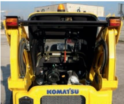
Capó: revisión rápida del motor
