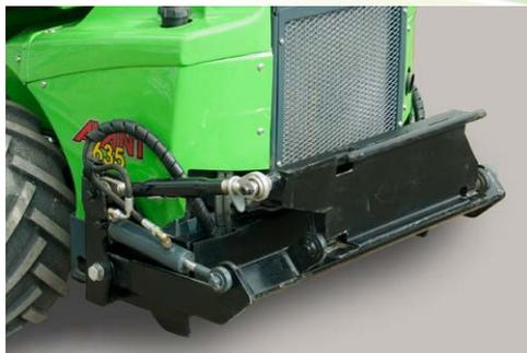
El dispositivo hidráulico de elevación trasero permite montar algunos accesorios en la parte trasera de la máquina, por ejemplo, un esparcidor de arena o un rotovator. Puede ser utilizado junto con un cazo o una pala en la parte delantera al mismo tiempo. El dispositivo de elevación trasero viene con una salida hidráulica auxiliar de doble efecto y está equipado con una posición flotante.
