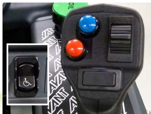
El control de conducción manual permite la marcha hacia adelante y hacia atrás de la motriz utilizando un interruptor en el joystick, en lugar de los pedales. El control manual es proporcional a su accionamiento, como los pedales: cuanto más se gira el interruptor, más rápido se desplazará la máquina. Las motrices con control manual conservan la opción de utilizar los pedales. La selección se realiza mediante un interruptor en el salpicadero.
