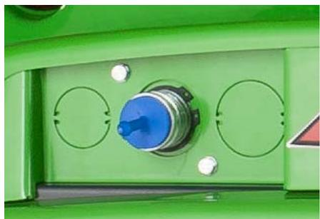
El sistema hidráulico auxiliar de acción simple está equipado con una única línea de presión. Permite el accionamiento de accesorios hidráulicos de una sola función.
