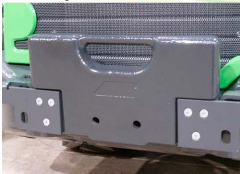
El contrapeso adicional de 29 kg se monta en el parachoques trasero. Está equipado con asa y ganchos de sujeción rápida, por lo que resulta simple fijar los pesos sobre la motriz y también conectar los pesos entre sí. Los acoplamientos de remolque A417323 y A417337 también se pueden montar sobre el peso.
