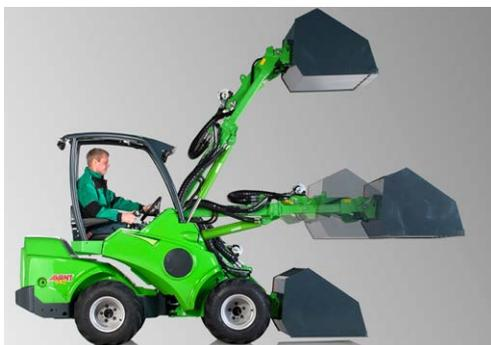
El sistema de autonivelación mantiene la posición del accesorio igual en relación con el suelo, independientemente de la posición del brazo. La autonivelación es hidráulica: hay un cilindro de nivelación en el lado izquierdo del brazo que sigue los movimientos del cilindro de inclinación del cazo y mantiene el nivel del accesorio. La autonivelación se desactiva cuando el brazo flotante está encendido.
