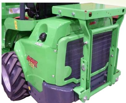
El portacargas trasero inclinable se monta sobre el parachoques trasero con pernos. Es requerido para montar en la parte trasera el generador, el compresor y el limpiador a presión.
