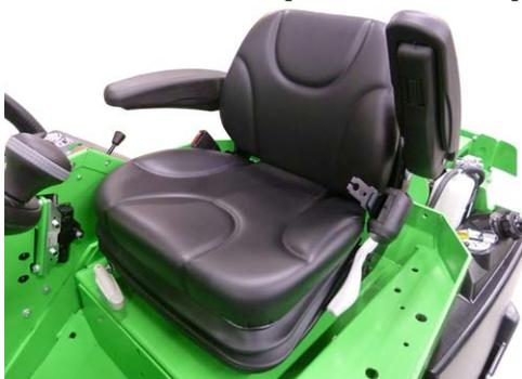
El asiento con suspensión completa tiene suspensión de mayor recorrido. Es estándar en las series 600 y 700. Está equipado con cinturón de seguridad, reposabrazos y calentador.
