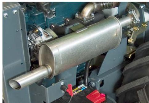
El purificador de escape se puede montar en lugar del silenciador de escape estándar. Reduce las emisiones de los motores diesel.
