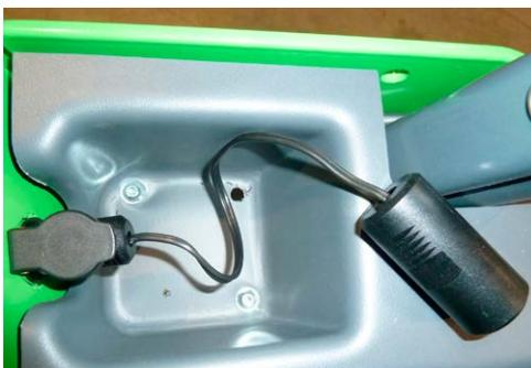
Se monta en la toma de 12V de las series 300-700 y en la primera serie 200. Equipado con un conector donde se puede conectar un enchufe para encendedor de cigarrillos, por ejemplo para utilizar un cargador de teléfono móvil.
