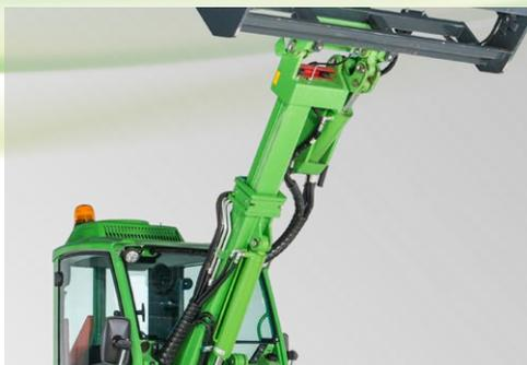
Dependiendo del modelo, el brazo telescópico da entre 400 y 700 mm más de alcance y unos 400 mm más de altura de elevación, lo que facilita mucho el alcance y carga de objetos. También permite ajustar de forma simple la distancia entre las ruedas delanteras y el accesorio. Puede incluso empujar la cargadora con el brazo telescópico en caso de ser necesario.
