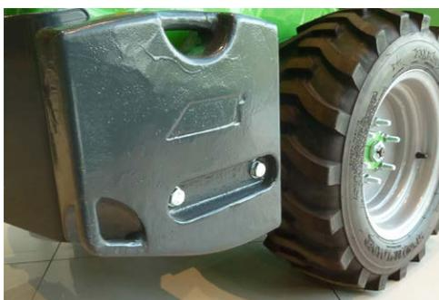
Los pesos laterales traseros se montan detrás de las ruedas traseras, sobre el parachoque. Se entregan por pares: uno para el lado izquierdo y otro para el derecho. El peso del kit es de 80 kg, y está destinado principalmente a la serie 400, pero es compatible con Avants mayores también.
