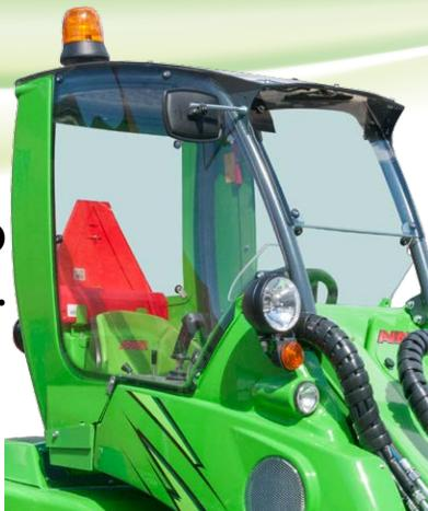
La cabina Avant L es una opción excelente y económica para dotar al operador de protección contra la lluvia, el viento y las nevadas. Mejora considerablemente su comodidad y las condiciones de trabajo. La cabina se monta sobre la estructura de protección antivuelco estándar ROPS, garantizando la seguridad del operario. Se compone de parabrisas (equipado con limpiaparabrisas y lavador), ventana lateral derecha y ventana trasera. La puerta está disponible para las cabinas L de la serie 200.
