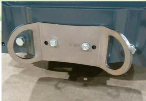
El soporte se puede montar en el parachoques trasero y / o detrás de las ruedas traseras. Facilita la sujeción de la motriz cuando es transportada en remolque o camión.
