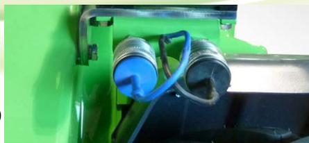
Complementa a la salida hidráulica auxiliar estándar de la parte delantera. Es de acción doble (presión-retorno) y presenta acopladores rápidos convencionales. Cuando la salida frontal extra está instalada, la salida hidráulica auxiliar trasera no puede ser instalada, y viceversa.
