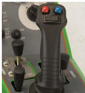
En el joystick de 8 funciones, tanto el sistema hidráulico auxiliar como el brazo telescópico pueden controlarse con los interruptores del joystick. Esto acelera tanto la carga como el trabajo con accesorios hidráulicos.
