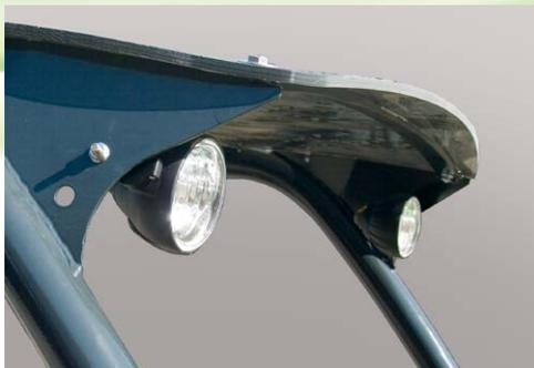
El kit de luz de trabajo consta de tres luces LED: 2 en la parte delantera, 1 en la parte trasera. Dos tipos de luces LED disponibles: 700 lúmenes o 2400 lúmenes.
