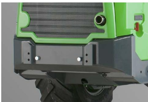
Las series Avant 500 y 600 están equipadas con el parachoques trasero de 170 kg de serie, pero si se requiere una máquina más ligera -por ejemplo para operar sobre superficies con capacidad de carga limitada- se puede instalar el parachoques trasero ligero en lugar del parachoques estándar. Esto reduce el peso total de la máquina en unos 150 kg.
