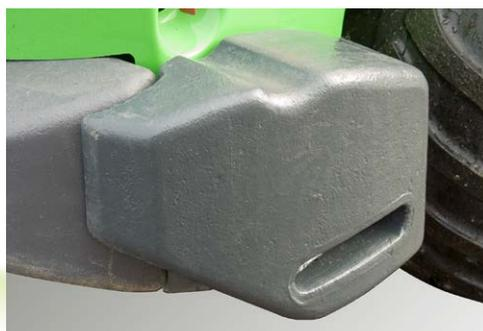
Los pesos laterales traseros se montan detrás de las ruedas traseras, sobre el parachoque. Se entregan por pares: uno para el lado izquierdo y otro para el derecho. El peso del kit es de 180 kg.
