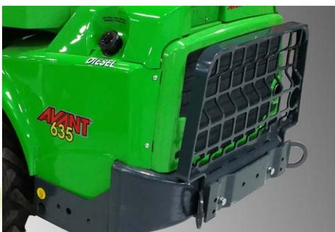
El parachoques trasero protege la parte trasera y el radiador del motor. Se monta con cuatro pernos y es fácil de instalar y desinstalar. Está equipada con soportes de sujeción y permite montar los contrapesos traseros y/o el acoplamiento del remolque al mismo tiempo.
