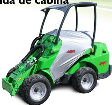
La funda protectora protege la cabina contra la lluvia, la nieve, el polvo y la suciedad. El tejido resistente a la intemperie cubre todo el panel de instrumentos, el volante y el asiento del conductor. La funda protectora tiene una bolsa integrada donde puede ser guardada cuando no esté siendo usada.
