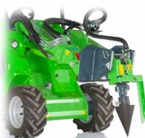
**A37500 Separador de troncos con cabezal cónico de rosca**
