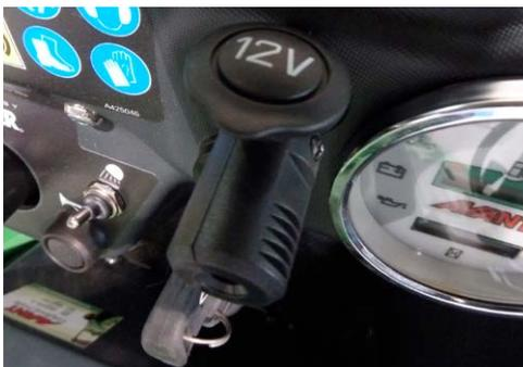
Adaptador de enchufe a la toma de 12V, se monta en la salida de 12V pequeña, presente en las series 300-700, y en la salida más grande, presente en la nueva versión de la serie 200. Puede conectar los cables eléctricos de cualquier aparato electrónico de 12V (por ejemplo, un cargador de batería) a este adaptador. Requiere por lo tanto algunos conocimientos de electricidad.
