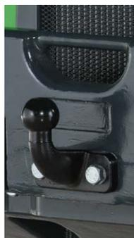
Hay dos tipos de acoplamientos de remolque disponibles: un enganche de bola de 50 mm y un enganche de bola de 50 mm con pasador de remolque. Ambos pueden ser montados directamente en el parachoques trasero o en el contrapeso trasero adicional. La serie 200 de Avant está equipada con un enganche de bola de 50 mm de serie.
