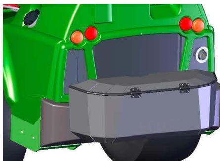
La caja de herramientas con cierre se monta en el parachoques trasero.
