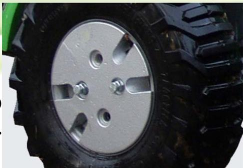
La serie 200 de Avant puede equiparse con pesos de rueda de 14 kg que se montan en la llanta con tornillos especiales. Hacen que el centro de gravedad de la máquina sea más bajo y que aumente el peso, lo que mejora la estabilidad de la motriz.
