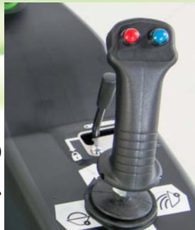
En el joystick de 6 funciones el funcionamiento del sistema hidráulico auxiliar (accesorios accionados hidráulicamente) es controlado con dos botones del joystick. Esto hace que el trabajo sea más rápido y más cómodo, ya que no es necesario mover la mano del joystick a la palanca de control hidráulico auxiliar cuando se opera el accesorio, y también se puede levantar el brazo e inclinar el accesorio al mismo tiempo si es necesario.
