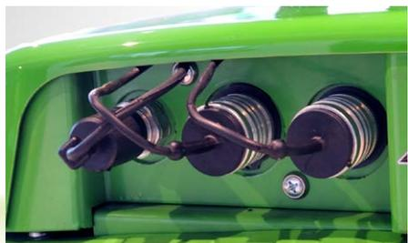
En las series 400 a la 700 también incluyen línea de tanque. Permite el funcionamiento de accesorios hidráulicos montados en la parte trasera, como el tráiler basculante, el esparcidor de arena, etc.
