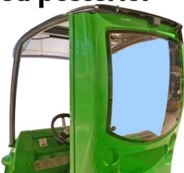
La pared trasera se monta sobre la estructura antivuelco ROPS. Proporciona protección contra el viento y la lluvia ligera.
