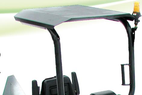
El techo protector FOPS de la serie 300 está montado sobre una estructura antivuelco ROPS serie 300.
