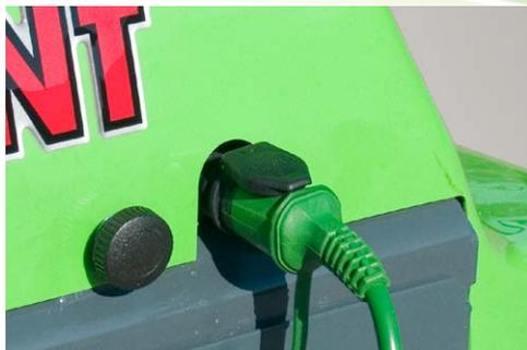
El calentador del motor facilita el arranque a bajas temperaturas ambientales, reduce el desgaste del motor y el consumo de combustible al arrancar en frío.
