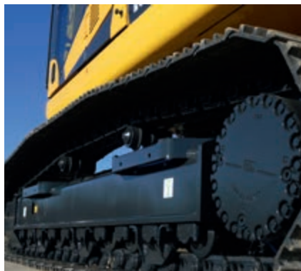
Protección completa de los rodillos del tren de rodaje (opcional)
