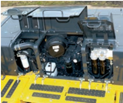
Fácil acceso a los filtros en la parte frontal del capó del motor
