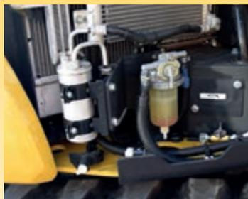
Filtro y prefiltro de combustible de mayor tamaño con decantador de agua que protegen el motor
