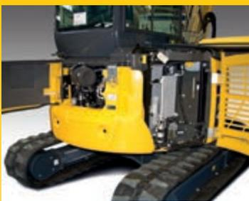
Capós traseros para revisión rápida del motor, inspección rápida, limpieza de los radiadores y fácil acceso a la batería
