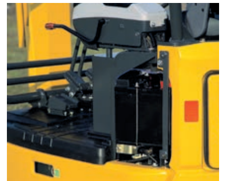
Capó izquierdo: fácil acceso a la batería
