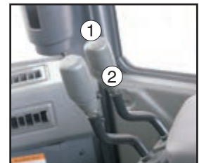
1. Conmutador del kick down 2. Conmutador de retención de la transmisión
