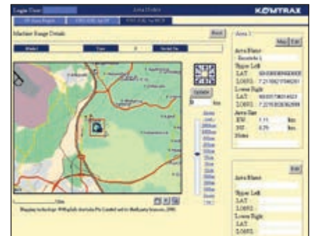
Seguridad añadida – La característica “bloqueo del motor” permite programar cuando se puede encender una máquina. Con la opción “geo-fence”, KOMTRAX™ le envía una notificación cada vez que su máquina traspasa una determinada área de operación predeterminada.
