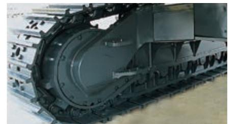
Robustas protecciones de los motores de traslación
