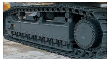
Protección completa de los rodillos del tren de rodaje (opcional)
