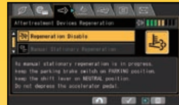
Pantalla de regeneración del dispositivo de emisiones para KDPF
