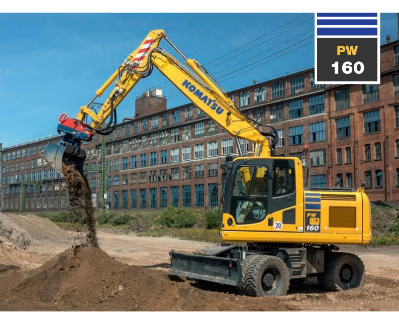
Excavadora hidráulica sobre ruedas
