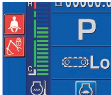
Testigos de aviso cinturón de seguridad y detección de posición neutra de los mandos
