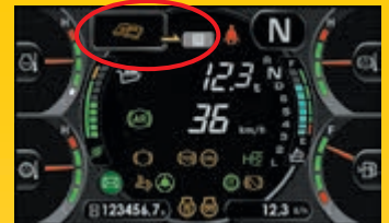
Precavión por mantenimiento
