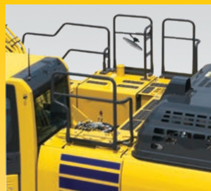
Barandillas y placas antideslizantes
