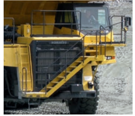
Acceso seguro a la cabina gracias al ángulo bajo de las escaleras delanteras, antideslizante y con barandilla
