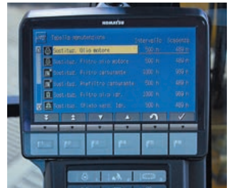
La pantalla LCD informa sobre las anomalías y las fechas de sustitución
