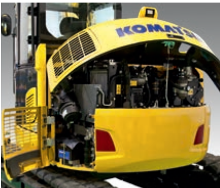
Todos los puntos de mantenimiento principales son fácilmente accesibles desde el nivel del suelo
