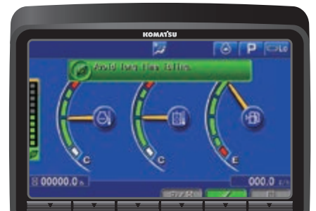
Ecoindicador, guía de eficacia, aviso de ralentí y apagado automático a ralentí ajustable ayudan a reducir el consumo de combustible
