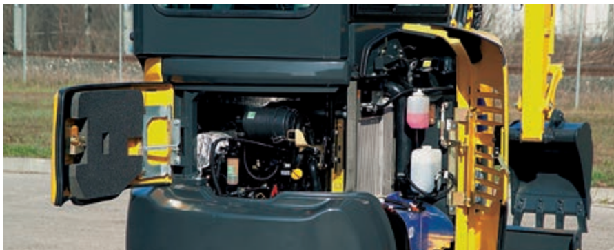
Capós traseros para revisión rápida del motor, inspección rápida, limpieza de los radiadores y fácil acceso a la batería
