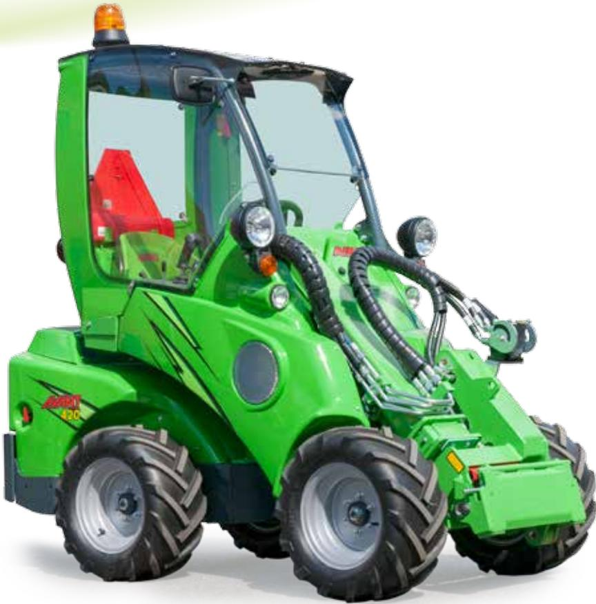
Las Minicargadoras Avant están equipadas de serie con un chasis de seguridad certificado, ROPS/FOPS, con techo de plexiglás tintado. Adicionalmente, disponemos de tres diferentes tipos de cabina.
