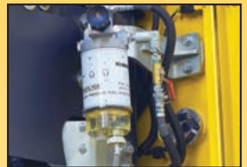
Separador de agua en el circuito del combustible de serie
