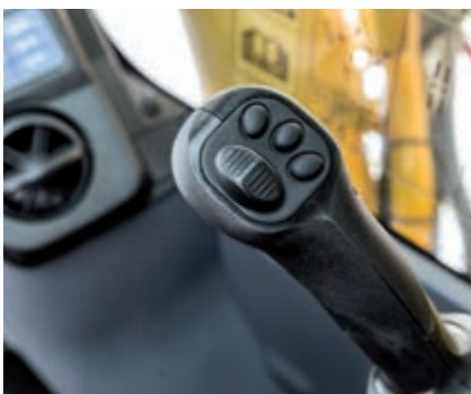
Joysticks con botón de control proporcional para los implementos
