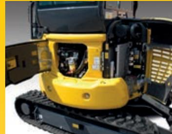
Capós traseros para revisión rápida del motor, inspección rápida, limpieza de los radiadores y fácil acceso a la batería
