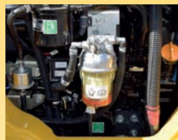
Filtro y prefiltro de combustible de mayor tamaño con decantador de agua que protegen el motor
