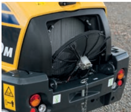
Ventilador abatible le permite un acceso fácil para la limpieza del radiador
