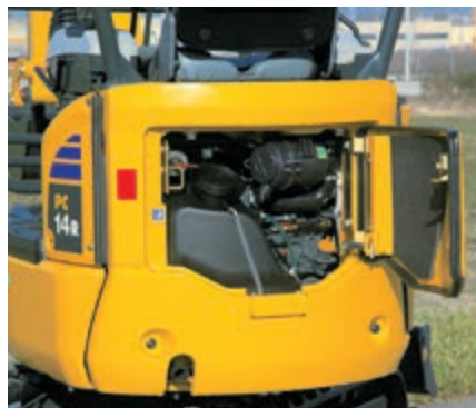
Capó trasero: revisión rápida del motor y llenado del depósito de combustible
