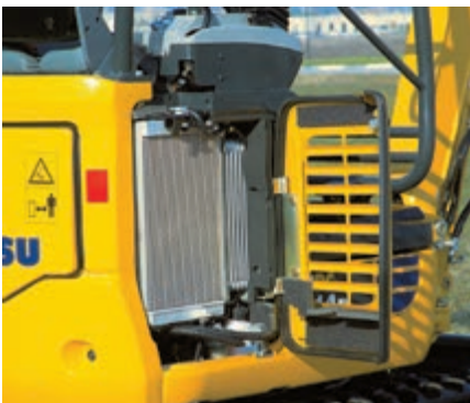
Capó derecho: inspección rápida y limpieza de los radiadores
