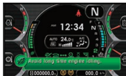
Ecoindicador y guía de eficacia con recomendaciones activas ayudan a maximizar el ahorro de combustible
