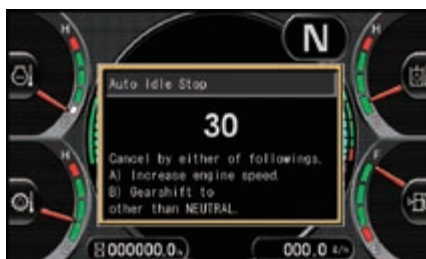
El apagado a ralentí ajustable apaga el motor automáticamente transcurrido un periodo de tiempo determinado
