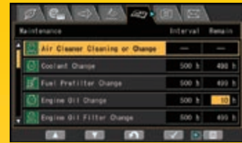
Pantalla de mantenimiento básico
