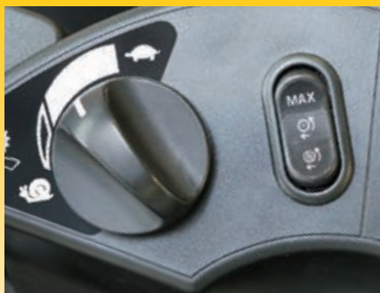
Control de desplazamiento variable con nuevo rango de velocidad de avance mínimo (izquierda) e interruptor del sistema de control de tracción (derecha)
